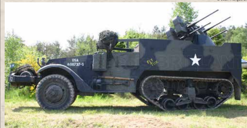
Half-track équipé de 4 mitrailleuses 12,7
