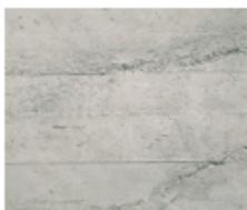
Le béton désigne un matériau de construction composite fabriqué avec des granulats (sable et/ou gravillons), agglomérés par un liant (souvent du ciment, quelquefois du bitume pour obtenir un béton bitumineux) et de l'eau.
