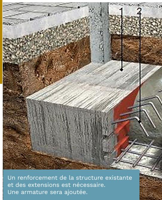
Un renforcement de la structure existante et des extensions est nécessaire. Une armature sera ajoutée.
